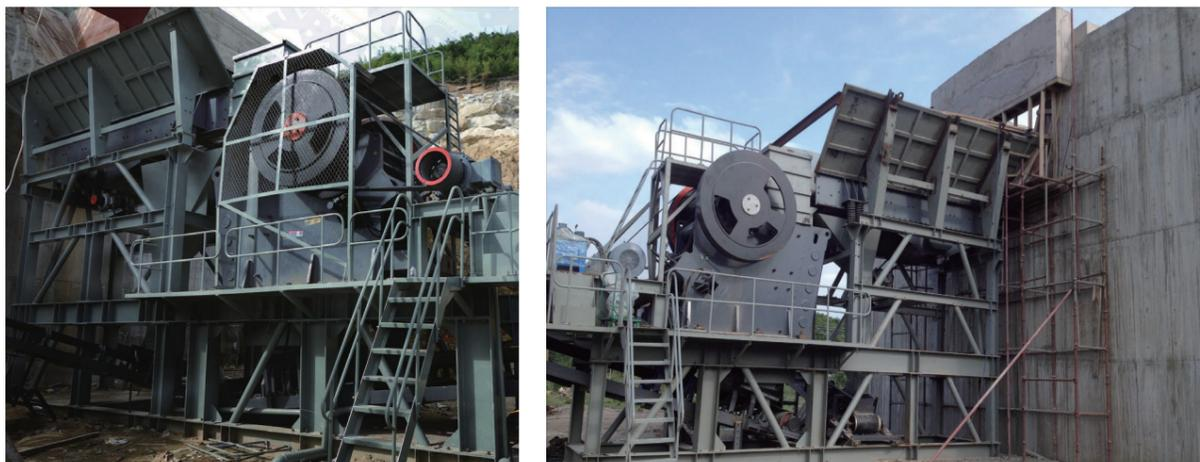
un dispositivo de ajuste mecánico o un dispositivo de ajuste hidráulico. Ajustar la abertura de descarga es conveniente y rápido, lo que reduce el tiempo de inactividad durante el ajuste.
